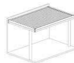
Adossée au mur 2 pieds déportés
