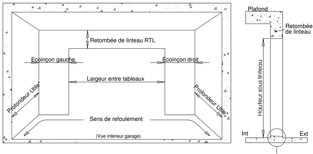
\* Profondeur utile pour porte non motorisée = Largeur entre tableaux - Ecoinçon + 600 (angle)
