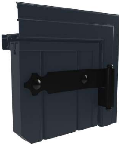
Précadre dormant : profil en aluminium avec aile de recouvrement assurant une parfaite jonction avec la maçonnerie existante et une occultation du volet sur 3 côtés.
