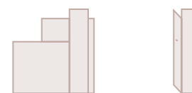
Ouverture 90° à 180° Selon la mise en œuvre du portail, entre piliers ou en arrière.
