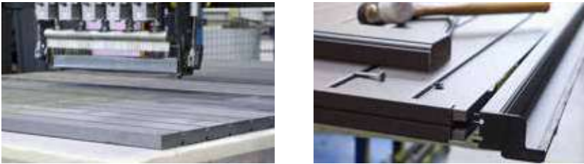
Les panneaux sandwich sont conçus dans notre atelier de fabrication. Nos volets ont des panneaux démontables pour faciliter les ajustements ou réparations.
