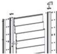
Système d'assemblage mécanique par Alvéovis
